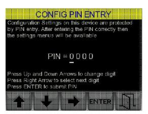
Mediante las flechas arriba, abajo y derecha el usuario puede seleccionar y cambiar cada parte del código pin y tecla "ENTER" irá al "Menú" si el PIN es correcto. Si el PIN no es correcto el usuario se ofrece la opción de volver a introducir el PIN o salir hacia el "menú de CONFIG" detallados en el la sección 4.1 arriba
