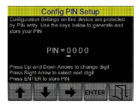
El usuario puede utilizar las flechas de "Arriba" y "Abajo" para cambiar el valor de la parte subrayada y el uso de la flecha de "Derecho" a elegir el número siguiente para cambiar.
