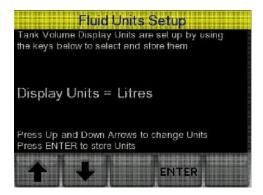
El usuario puede cambiar las unidades por el para arriba y abajo flechas y presionar "ENTER" para seleccionar sus unidades de elección. A continuación, pulse "EXIT" para volver al menú" configuración"
