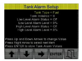
El usuario puede seleccionar alarmas de nivel altos y bajos para cada tanque y el nivel de alarma para cada tipo de alarma.
