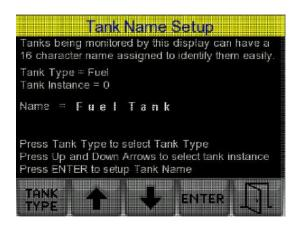
El primer paso el usuario debe seleccionar el tipo de depósito que está siendo denominado pulsando el botón de "Tank Type". Esto pasará alrededor de todos los tipos de depósito disponibles y la pantalla debe dejarse en el tipo de tanque a ser nombrado.
